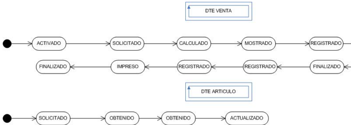
Figura 63. Diagramas de máquina de estados obtenidos a partir del Esquema Preconceptual de la Figura 60.
